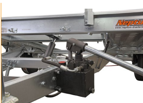
N15-380 alb: Pogon s integriranom hidrauličkom pumpom za naginjanje platforme
